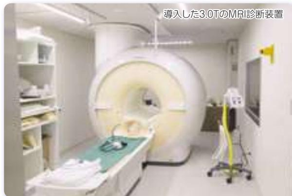
今回導入した3.0TのMRI診断装置では、従来の1.5TのMRI診断装置と比べて、より精細な画像が簡単に得られ、これまで不鮮明だった細い血管や動脈瘤などの病変をはっきり確認することができます。
